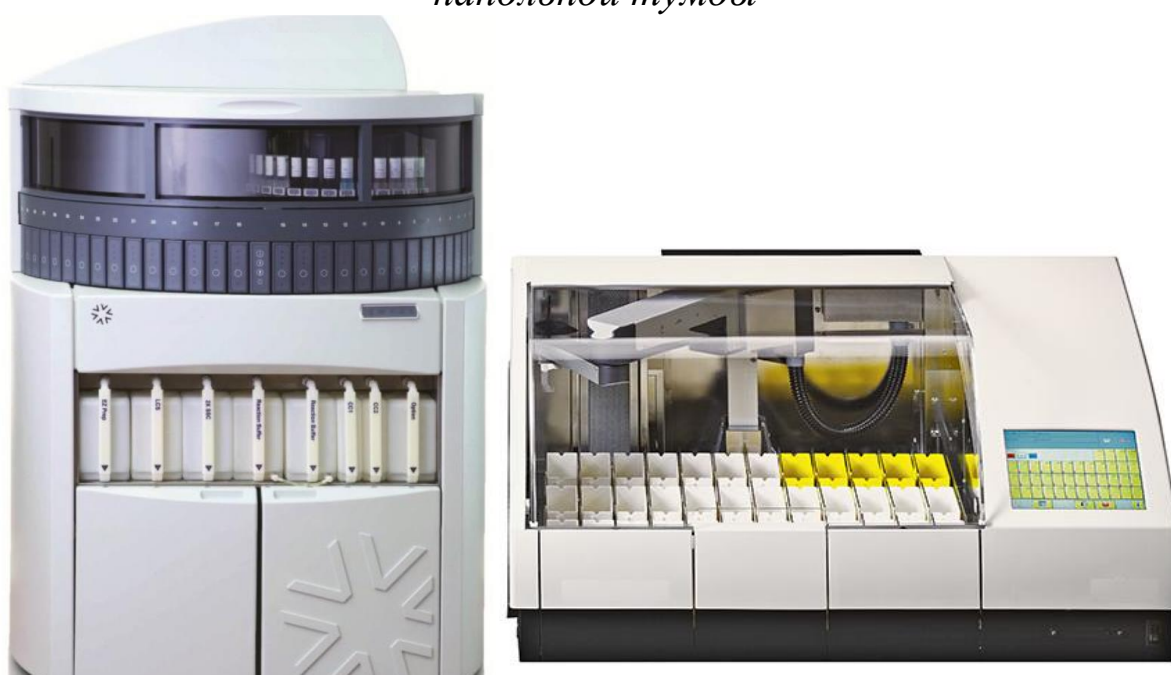
Современные образцы иммуногистостейнеров вертикального и горизонтального типов
