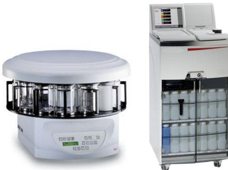
Современные образцы приборов для автоматизированной проводки тканевого материала карусельного типа и выполненные в виде напольной тумбы
